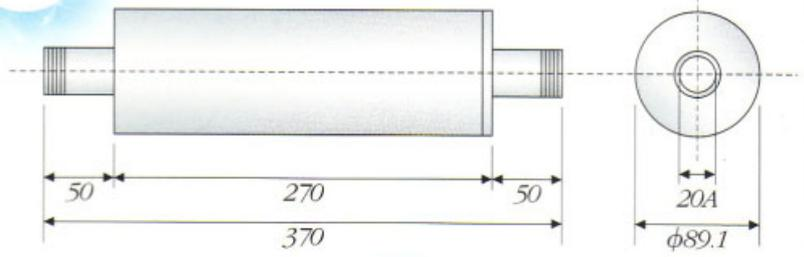
製品のサイズ / 直径89.1mm × 全長370mm
